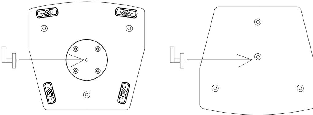
5- Coloque las dos anillas ACRM8 en dos puntos de fijación de la caja (1,2) para posteriormente, pasar la eslinga de seguridad (sólo en caso de disponer del kit opcional de seguridad SC15)
