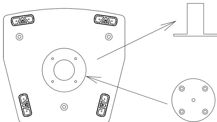
4- Coloque los dos pomos de M8 en los dos puntos de fijación de la parte superior e inferior de la caja. Asegúrese que las arandelas de goma queden entre el pomo y la caja
