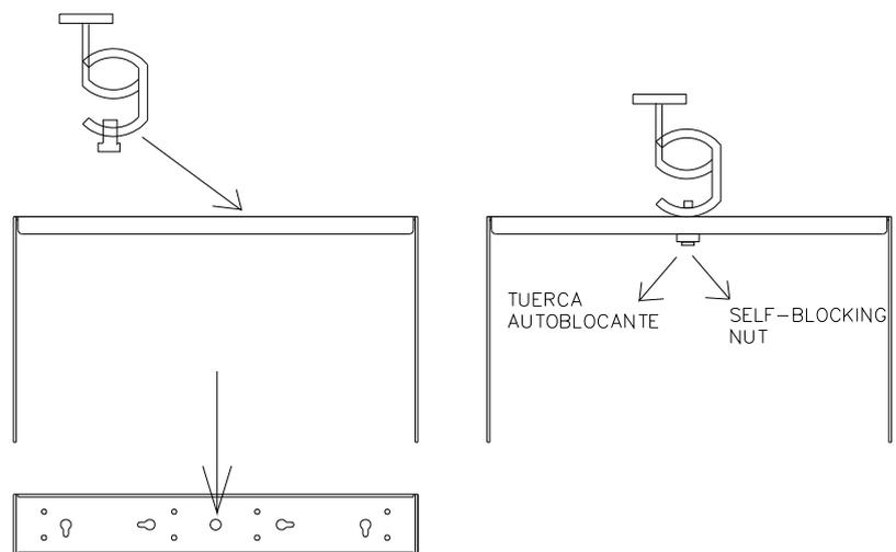
4- Colocar el soporte SP-8 en la caja. Fijar ambos laterales por los pomos de M8. Asegúrese que las arandelas de goma queden entre el soporte y la caja
