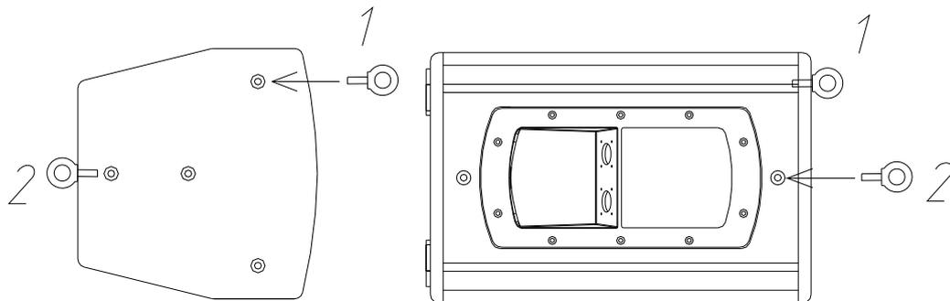
3- Colocar en el soporte SP-8 el accesorio opcional GT-50 (garfio para colgado). Bloquear correctamente con una tuerca autoblocante. Usar el punto central indicado con una flecha.
