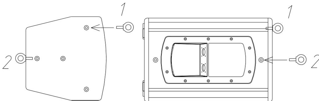
6- Coloque la caja entre el soporte y la pared y fjela con los dos pomos de M8. Las arandelas de goma deben quedar situadas entre el soporte y la caja.
