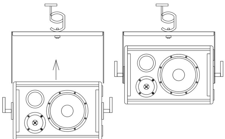
5- Fijar todo el sistema en la estructura de colgado. Asegurar el garfio.
