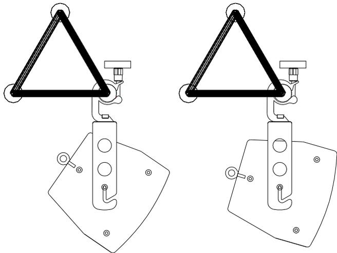
7- Puede usar la eslinga como medida de seguridad adicional, colocándola por el interior de las anillas ACRM8. En este caso, la eslinga debe fijarse a la barra del truss.
